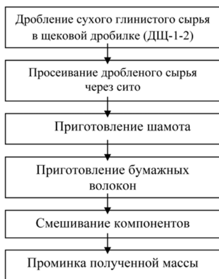
Рис. 2. Технологическая схема приготовления керамической массы
