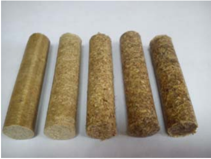
Рис. 2. Образцы древеснонаполненного композита с силиконовым связующим
